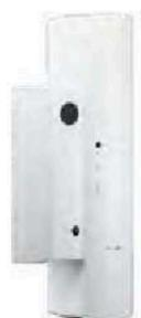
Adatto per la protezione di ambienti con ampie vetrate (finestre, verande, ecc.). È utilizzabile in presenza di vetrate con spessore fino a 6,4 mm. Raggio d'azione da 3,5 a 6 m a seconda del tipo di vetro e del suo spessore. Grazie al microfono incorporato, è in grado di rilevare le frequenze acustiche emesse dalla rottura di un vetro.
